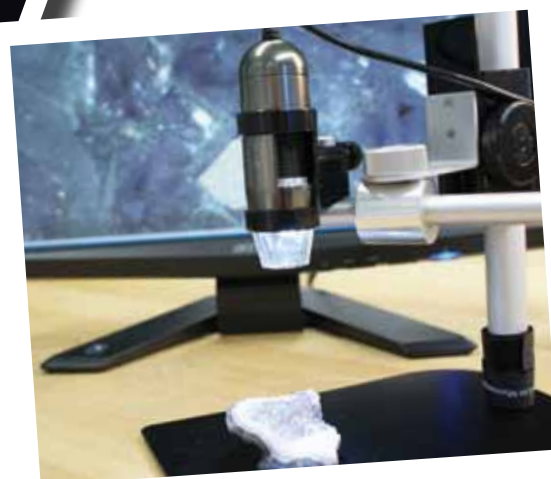
Inspektion av skuren diamant, förstoring 50x
