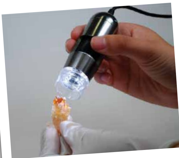
Kontroll av ädelsten med Dino-Lite USB-mikroskop
